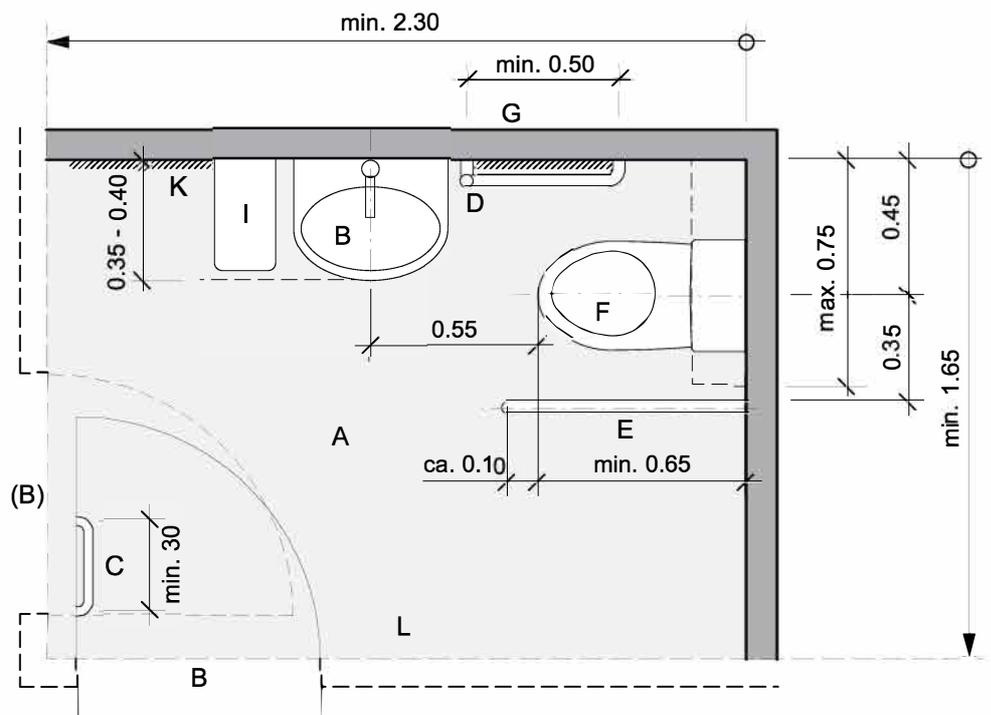
Bei nach innen öffnender Türe muss das Längen- oder Breitenmass um mindestens 0.50 m gegenüber dem Normalmass von 1.65 x 1.80 m vergrössert werden!
